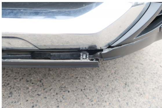
Abbildung 4: Schadenbereich Lexus RX 450 H
