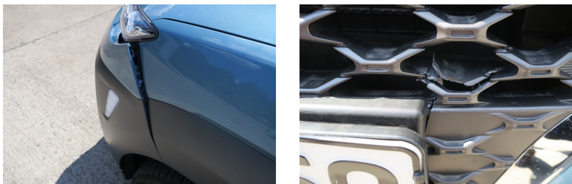
Abbildung 1: Schadenbereich Hyundai Kona
