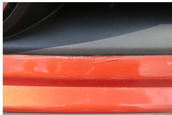
Abbildung 2: Schadenbereich VW Polo IV
